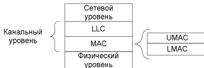
Рис.6. Подуровни канального уровня в разделяемых системах
