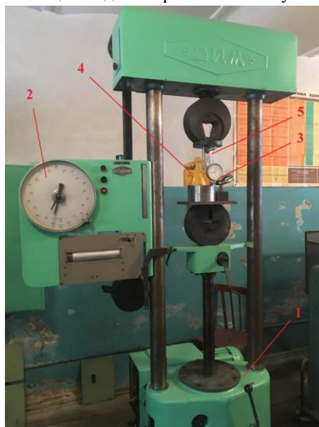
Рис. 2. Общий вид экспериментальной установки: 1 — механический пресс; 2 — динамометр; 3 — индикатор перемещения; 4 — опытный образец долота АД-160; 5 — специальный индентор
