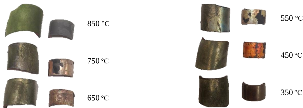
Рис. 7. Сравнение наружной поверхности образцов после нагрева до указанных температур: слева — образцы с покрытием, справа — образцы из чистой меди
