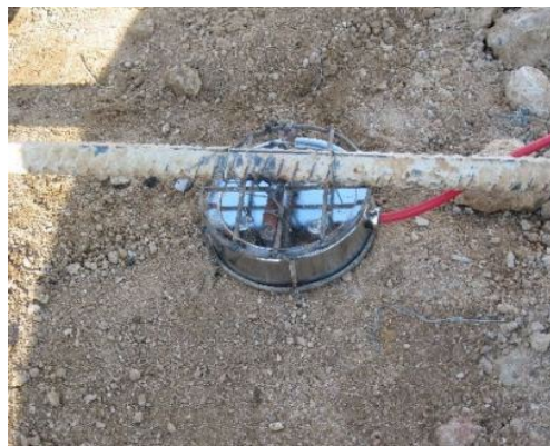
Рис. 3. Датчик для регистрации давления в грунте и на поверхности слоев основания [18]
