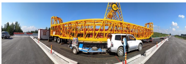
Рис. 1. Установка для испытаний на ускоренную нагрузку [8]
