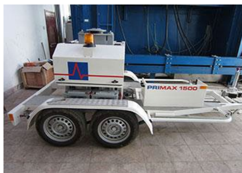
Рис. 6. Установка ударного нагружения FWD [20]
