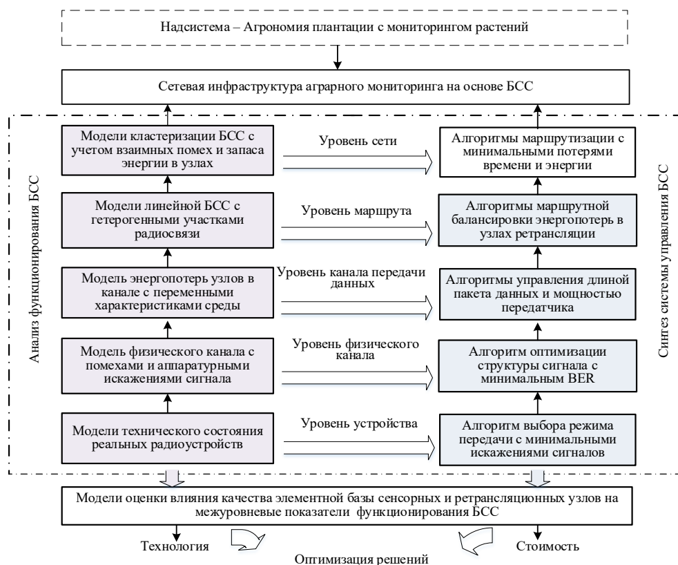
Рис. 1. Схема многоуровневой сетевой инфраструктуры мониторинга агропромышленных объектов на основе беспроводных сенсорных сетей
