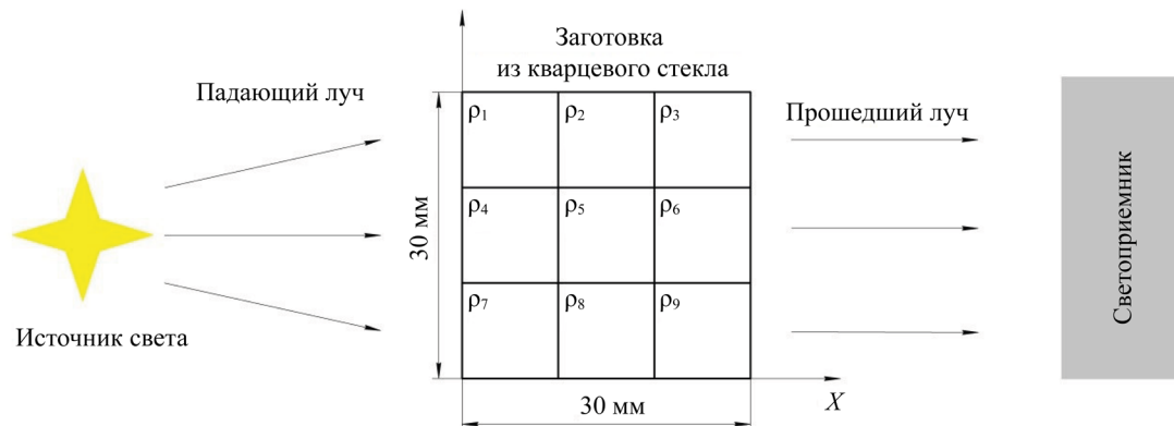
Рис. 1. Расчетно-экспериментальная схема для идентификации разнотности
