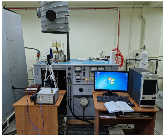
Рис. 1. Экспериментальная установка для зажигания газоразрядной плазмы:
