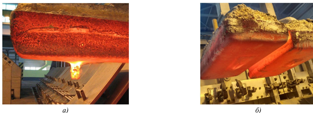
Рис. 1. Деформация поверхности анода: а — типичный конус; б — конус «отставание»
