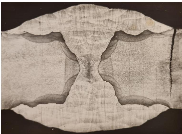
Рис. 1. Характер разрушения сварного стыкового соединения (фото авторов)
