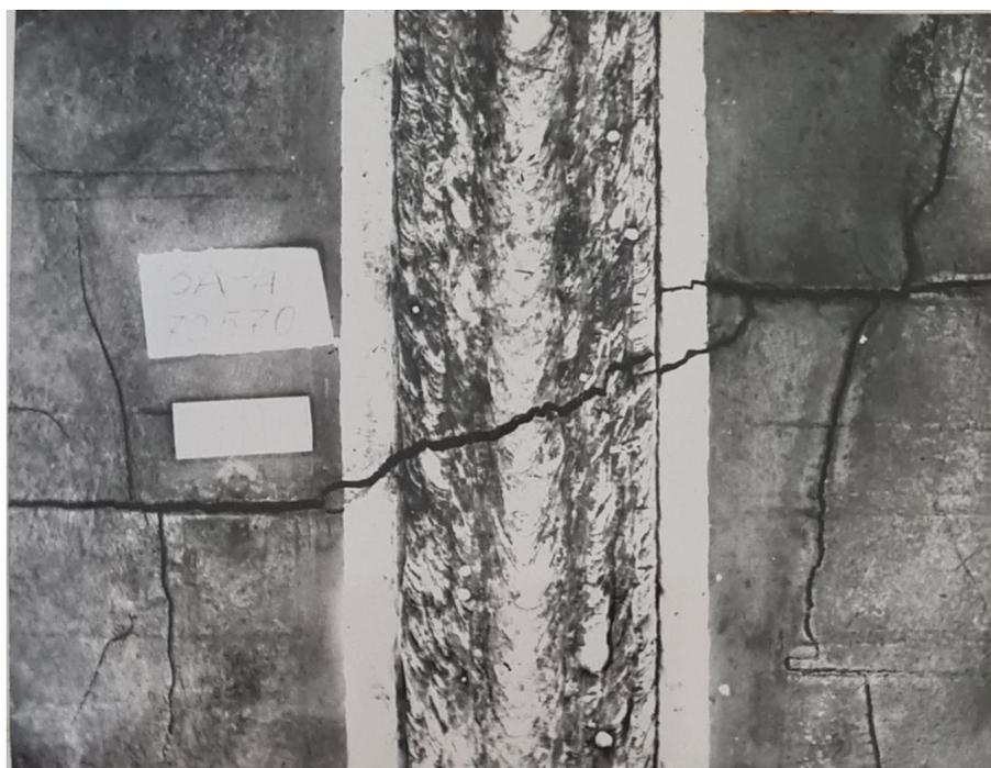
Рис. 5. Характер зарождения и развития разрушения сварного соединения, зона сопряжения которого прокатана между узкими роликами (6-й способ): а — кинограмма развития разрушения образца; б — внешний вид сварного соединения при разрушении (фото авторов)
