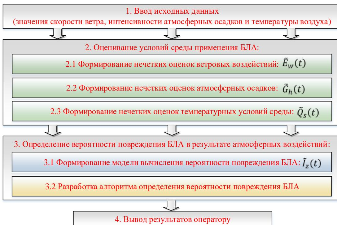
Рис. 1. Функциональная схема методики определения вероятности повреждения БЛА в результате воздействия атмосферных факторов среды
